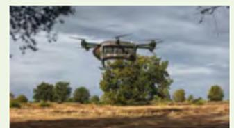
Die Grille verfügt über sechs Rotoren und kann Lasten von bis zu 130 Kilogramm transportieren. Foto: AVILUS GmbH
